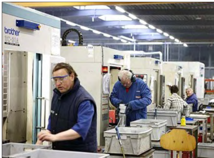
Een straat van 15 machines wordt automatisch met emulsie bijgetankt wat onder meer een schonere werkomgeving oplevert en een aanzienlijke tijdbesparing
